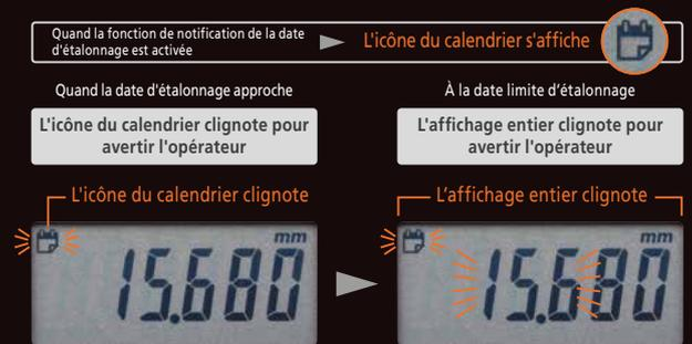
La date d'avertissement et la date d'alerte d'étalonnage programmé peuvent être réglées en un clin d'œil. Un avertissement s'affiche quand la date d'étalonnage approche et une alerte s'affiche à la date d'étalonnage programmé, pour ne pas risquer de l'oublier. Cette fonction est efficace pour une bonne gestion de l'instrument.
